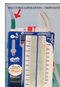
6- Vérifier la position du flotteur rouge. Celui-ci doit être en position centrale dans la fenêtre. Si le flotteur reste immobile, en position basse = il n'y a pas assez de flux en provenance du vide. Si le flotteur flotte trop, vers le haut = le flux est trop élevé.
